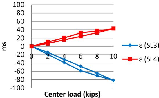
**FIGURE 7 STRAINS RECORDED FROM CENTER-POSITIVE BENDING TEST**
