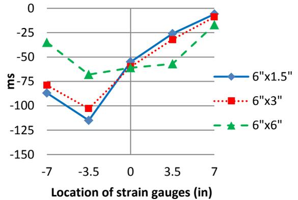
**FIGURE 9 COMPRESSIVE STRAIN DISTRIBUTION 2.5 INCHES ABOVE THE BOTTOM SURFACE**
