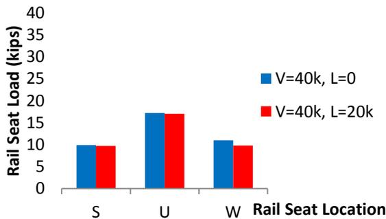
**FIGURE 10 DISTRIBUTION OF RAIL SEAT LOAD**
