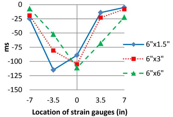
**FIGURE 8 COMPRESSIVE STRAIN DISTRIBUTION 5 INCHES ABOVE THE BOTTOM SURFACE**
