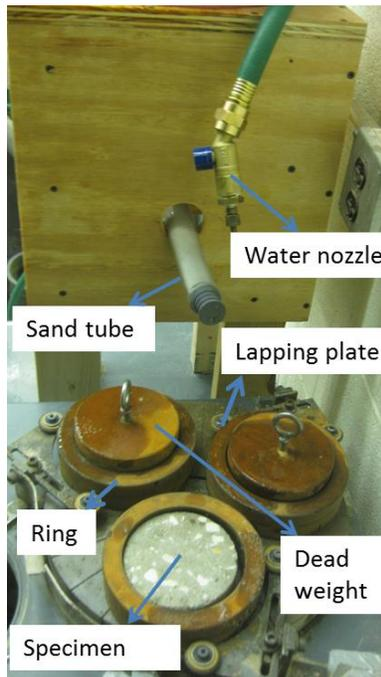
**FIGURE 2. SSART AND ABRASIVE SLURRY CONVEYANCE EQUIPMENT**
